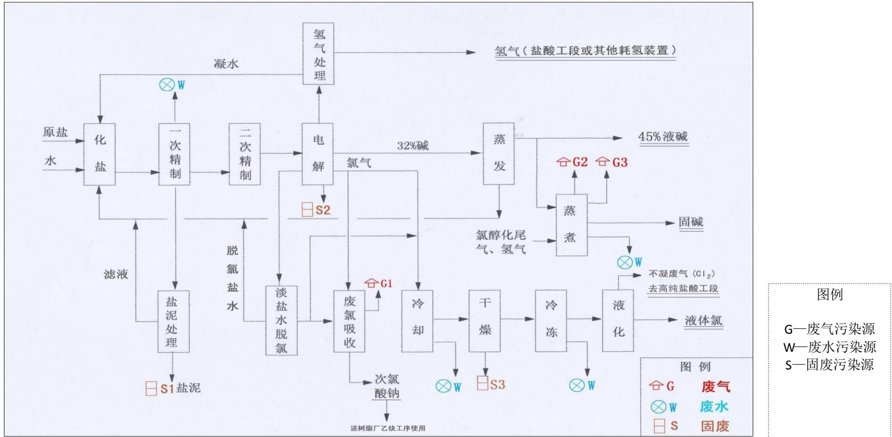
图 3-3 烧碱工艺流程及排污节点示意图
