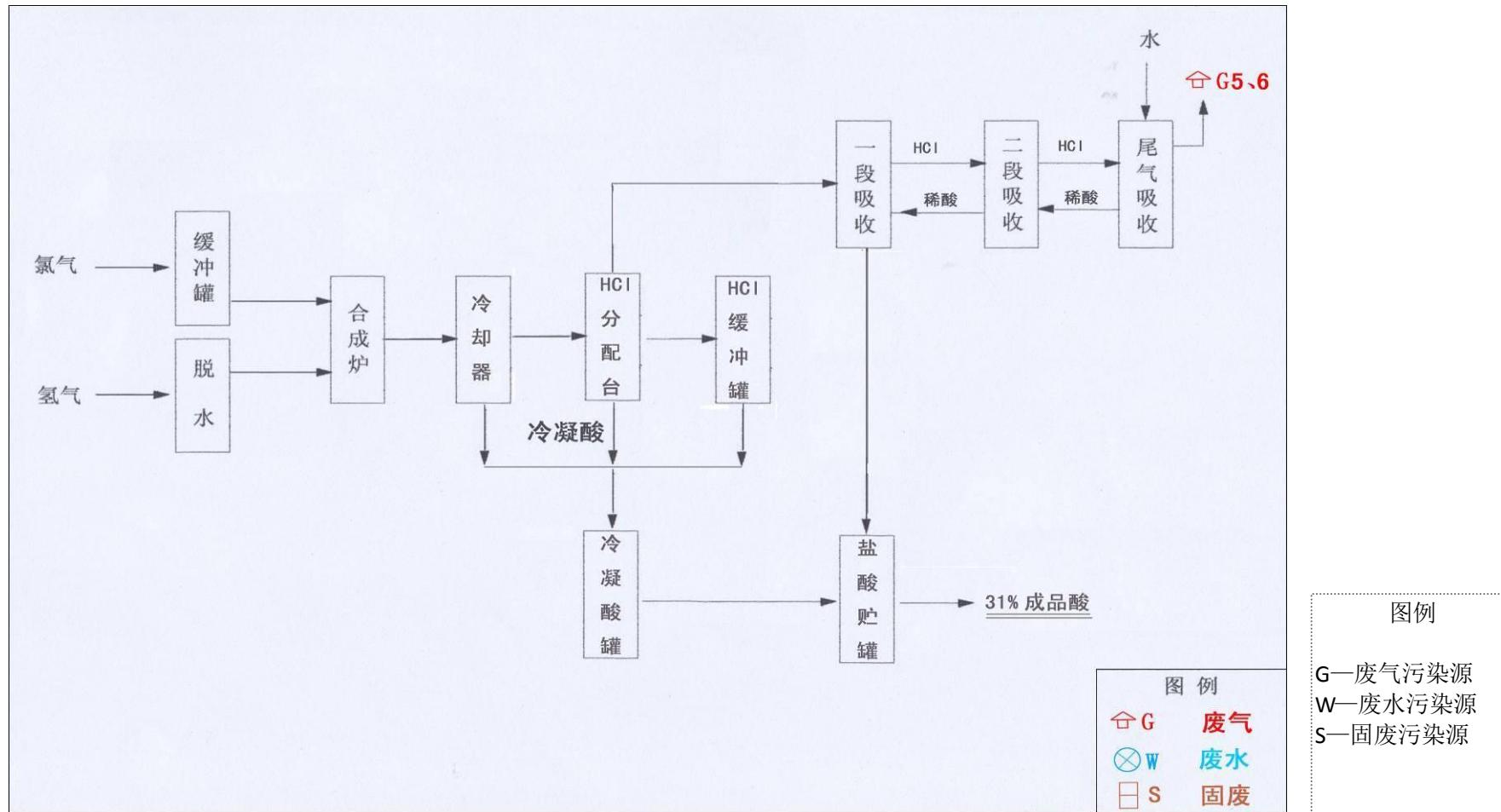
图 3-4 高纯盐酸工艺流程及排污节点示意图
